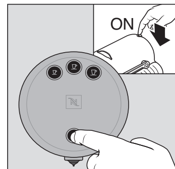
11. Drücken und halten Sie die Heisswassertaste während Sie die Maschine einschalten.
