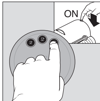
2. Drücken und halten Sie die Lungotaste während Sie die Maschine einschalten.
